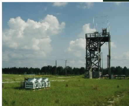
Искусственная молния, стимулированная небольшой ракетой, запущенной с деревянной вышки во время грозы (см. фото вверху). Ракета тянет за собой провод, по которому от земли проходит ток, создающий дорожку для удара молнии. Размещенные вблизи приборы измеряют энергию и интенсивность испускаемых рентгеновских лучей.
